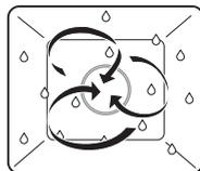
Воздух в камере нагревается нагревательным элементом, расположенным за задней стенкой камеры, и равномерно циркулирует. Из камеры выводится минимальное количество возникающего пара. Влажность продуктов сохраняется.
