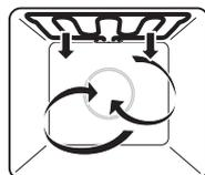
Нагрев осуществляется с помощью нагревательного элемента гриля. Воздух в камере прибора циркулирует равномерно за счет нагнетателя горячего воздуха.
